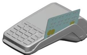
**Magnetstreifenkarten** werden mit dem Magnetstreifen nach links unten zeigend von hinten nach vorne zügig durchgezogen.
